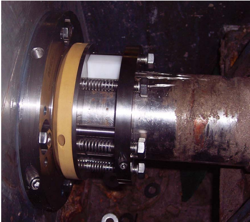
飲料製品用ドライ粉末ブレンダー へのOFS-II取り付け風景
