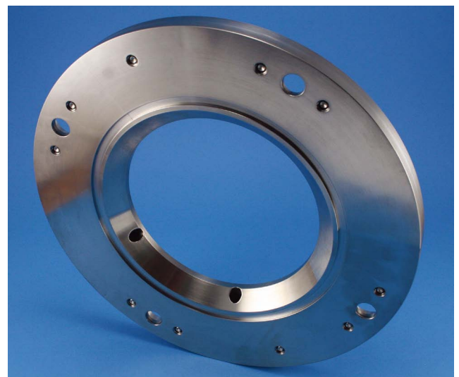
OFS-IIステーターを装置内側から見た写真 レベリング用ネジ穴とフラッシングポートが見える
