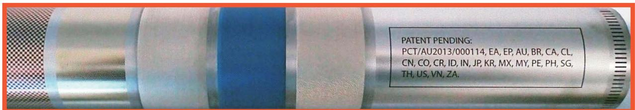
その工程の概要とは、まずコールドスプレーという新しい噴射技術によりベースロール表面にチタン粉末を低温で噴射、定着させ、その後最新型のレーザーシステムによって窒素ガスやヘリウムなどのガスを噴射させながら窒化による表面硬化と同時にアニロックス表面の彫刻を同時に行ってしまうという画期的な技術で、従来のセラミック工程に比べてはるかに高い生産加工効率を得る事が可能になったのです。
