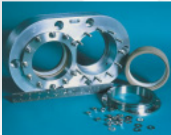
Werner&Pfleiderer社 ZSK-170型 エキストラクター仕様 2軸型 EX-PAC
