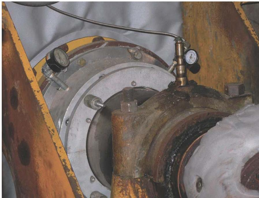
圧力ゲージでシールバージ圧力を監視し、乾燥機内の圧力より2psi以上の状態に保つことによって、完全な密閉を維持します。
