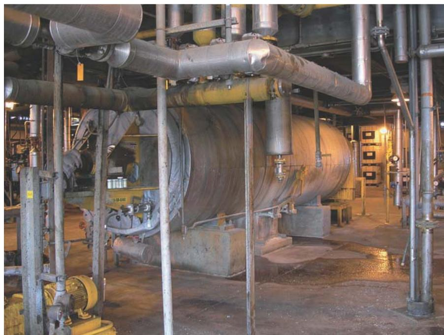
長さ約6mのジャケット付横型ロータリー真空乾燥機は、中を貫く中空軸を4rpm速度で回転させながら蒸気を使って2種類のペーストを乾燥させる。
