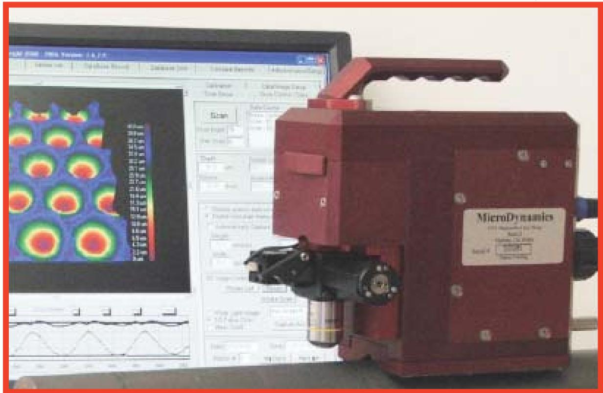
マイクロダイナミクス社が、表面粗さ精密計測の最先端技術である白色光干渉計を用いて、アニロックスセルのボリュームを手軽かつ精密に計測できるスコープとして2007年に開発、フレキソ印刷や表面コーティングプロセスの品質再現性を確保する上で最も重要な要素であるアニロックスロールの科学的管理を可能にします。
