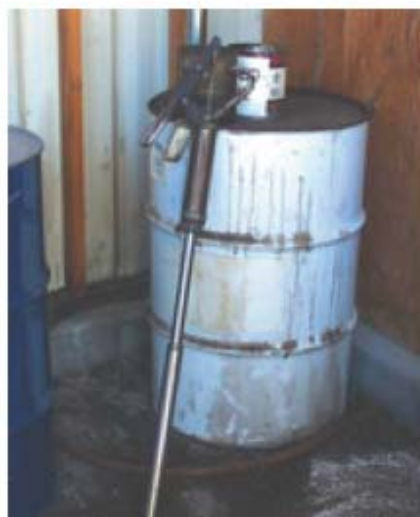
図 5. 不適切な作業工程のために、汚れたフィル・ポンプ
