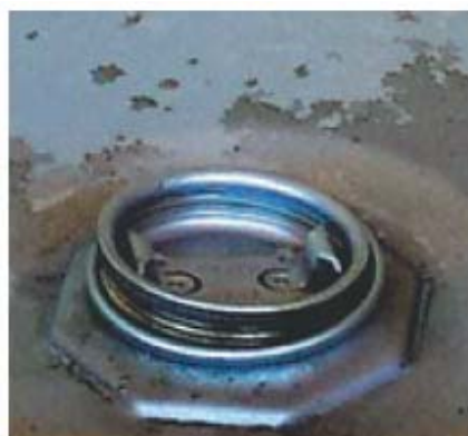
図 4. 不適切な保管工程のため、密閉されていないドラム缶の栓
