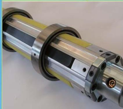
ATEMに特筆される機能であるセンタリングとグリップ機能に分かれた拡張ストライプのシステムは、シャークットナイフの下刃固定シャフトとして優れた性能を発揮します。センタリングのストライプだけにエア注入すると下刃は調芯された位置で固定されながらもスムーズに移動でき、正確な位置決めをしてからグリップストライプにエアを注入し完全に固定するので、ネジ止め方式に比べ格段に作業効率が向上します。
