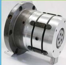
自己センタリング機能を持った、シャフトレス機用チャックです。コア内径70mmから500mmまでの仕様に対応出来ます。本体材質はスチール製で、機械との取り合い部はご指定のデザインで製作致します。
